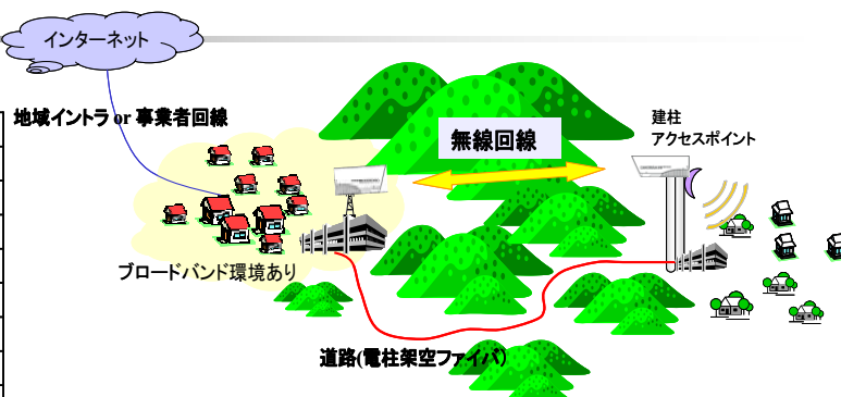
無線回線構築の場合とファイバ敷設の場合のイメージ図
