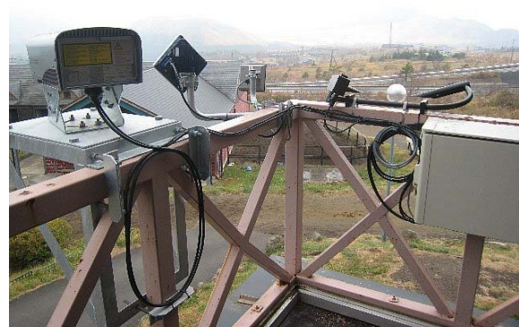
無線装置と視程計 (左から光無線,25GHz,2.4GHz, 視程計)
